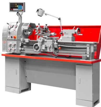
Die Holzmann ED1000NDIG\_400V Metalldrehbank mit Digitalanzeige ist ideal für Schlossereibetriebe, Werkstätten und Schulen. Die Maschine bietet eine einfache und rasche Drehzahländerung mittels Getriebeschaltung und ein stark verripptes Prismenbett aus Grauguss, das induktiv gehärtet und geschliffen ist.
