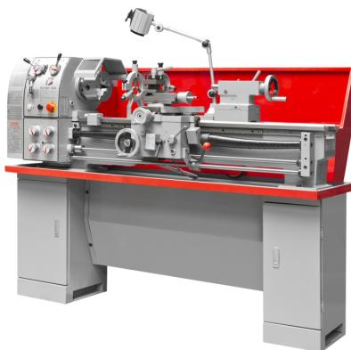
Die Holzmann ED1000N\_400V Metalldrehbank ist ideal für Schlossereibetriebe, Werkstätten und Schulen. Sie bietet eine einfache und rasche Drehzahländerung mittels Getriebeschaltung und ein stark verrippetes Prismenbett aus Grauguss, das induktiv gehärtet und geschliffen ist.
