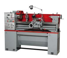
Die Holzmann ED1000F 400V Metalldrehbank ist eine vielseitige und besonders wertbeständige Leit- und Zugspindel Drehmaschine. Sie ist ideal geeignet für den Einsatz in Werkzeugbau, Fertigung und Ausbildungsstätten. Die serienmäßig übergroße Spindelbohrung mit Ø 52mm ermöglicht die Bearbeitung großer Wellendurchmesser. Die elektromagnetische Fußbremse sorgt für maximale Sicherheit und minimale Nebenzeiten durch sofortigen Spindelstopp.
