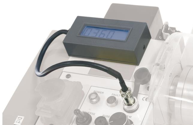
Digitale Drehzahlanzeige zur Selbstmontage.
