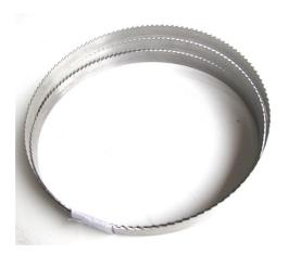
Das Holzmann BSB610B8 Bandsägeblatt ist für präzise Schnitte in Holz konzipiert. Es besitzt eine Länge von 4080 mm, eine Breite von 8 mm und eine Dicke von 0,65 mm. Das Sägeblatt verfügt über 6 Zähne pro Zoll.
