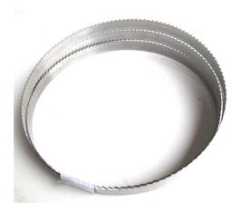
Das Holzmann BSB470B20 Bandsägeblatt ist ein hochwertiges Werkzeug für die Holzbearbeitung. Es bietet eine Länge von 3454 mm, eine Breite von 20 mm und eine Dicke von 0,8 mm. Das Sägeblatt ist ideal für präzise Schnitte in verschiedenen Holzarten.
