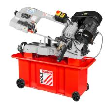
Die Holzmann BS712TOP\_400V Metallbandsäge ist eine solide Gussmaschine mit kugelgelagerter Sägebandführung. Sie verfügt über eine automatische Endabschaltung und einen Späneabscheider sowie eine Schmiermittelpumpe. Der Senkgeschwindigkeit des Sägearms kann über einen Hydraulikzylinder stufenlos eingestellt werden.
