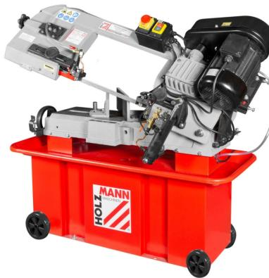
Die Holzmann BS712TOP\_400V Metallbandsäge ist eine solide Gussmaschine mit kugelgelagerter Sägebandführung. Sie verfügt über eine automatische Endabschaltung und einen Späneabscheider sowie eine Schmiermittelpumpe. Der Senkgeschwindigkeit des Sägearms kann über einen Hydraulikzylinder stufenlos eingestellt werden.
