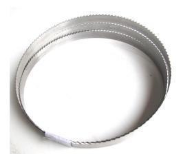
Das Sägeband Holzmann BS260GNIRO\_6/10 ist ein hochwertiges Werkzeug für die Holzbearbeitung. Es ist aus M42-Stahl gefertigt und weist eine Länge von 2455 mm, eine Breite von 27 mm und eine Dicke von 0,9 mm auf. Das Sägeband ist mit 6/10 Zähnen pro Zoll ausgestattet.
