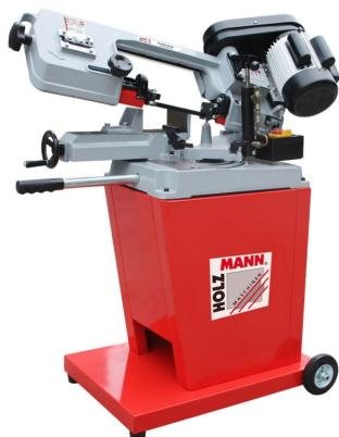
Die Holzmann BS128HDR\_400V Metallbandsäge ist eine solide Gussmaschine mit kugelgelagerter Sägebandführung. Sie verfügt über ein drehbares Sägeaggregat, eine automatische Endabschaltung und eine stufenlos einstellbare Senkgeschwindigkeit des Sägearms über Hydraulikzylinder. Die Maschine ist mit einem schnellverstellbaren Schraubstock und einem ausziehbaren Griff ausgestattet.
