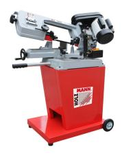
Die Holzmann BS128HDR\_230V Metallbandsäge ist eine solide Gussmaschine mit kugelgelagerter Sägebandführung. Sie verfügt über ein drehbares Sägeaggregat, eine automatische Endabschaltung und eine senkgeschwindigkeitsgesteuerte Hydraulik. Die Maschine ist mit einem schnellverstellbaren Schraubstock und einem ausziehbaren Griff ausgestattet.
