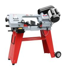
Die Holzmann BS115\_400V Metallbandsäge ist eine solide Gussmaschine mit kugelgelagerter Sägebandführung. Sie verfügt über eine automatische Endabschaltung serienmäßig und eine einstellbare Senkgeschwindigkeit des Sägearms über Feder. Der schwenkbare Schraubstock kann zwischen 0°-45° eingestellt werden. Im Gestell befindet sich ein Ablagefach für diverse Werkzeuge.
