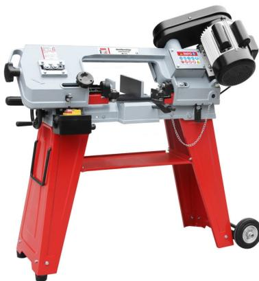
Die Holzmann BS115\_230V Metallbandsäge ist eine solide Gussmaschine mit kugelgelagerter Sägebandführung. Sie verfügt über eine automatische Endabschaltung und eine einstellbare Senkgeschwindigkeit des Sägearms über Feder. Der schwenkbare Schraubstock kann von 0° bis 45° eingestellt werden. Im Gestell befindet sich ein Ablagefach für diverse Werkzeuge.
