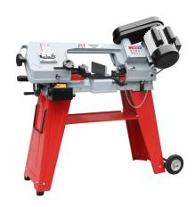
Die Holzmann BS115\_230V Metallbandsäge ist eine solide Gussmaschine mit kugelgelagerter Sägebandführung. Sie verfügt über eine automatische Endabschaltung und eine einstellbare Senkgeschwindigkeit des Sägearms über Feder. Der schwenkbare Schraubstock kann von 0° bis 45° eingestellt werden. Im Gestell befindet sich ein Ablagefach für diverse Werkzeuge.
