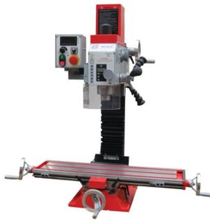
Die Holzmann BF25VLN\_230V Fräsmaschine MK3, XL Tisch ist ideal für Lehrwerkstätten, Feinmechaniker und Hobbybastler. Sie bietet eine variable Drehzahlregelung mit digitaler Drehzahlanzeige und eine digitale Bohrtiefenanzeige mit Abnullfunktion. Der XL-Kreuztisch mit 700x180mm und die schwenkbare Getriebefräskopf erweitern die Einsatzmöglichkeit.
