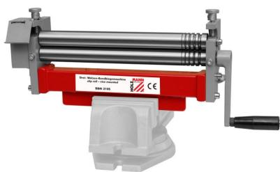
Die Holzmann BBM310S ist eine universell einsetzbare 3-Walzen-Rundbiegemaschine, die für das Biegen und Rollen von Blech, Draht usw. geeignet ist. Sie bietet individuelle Einstellmöglichkeiten für Rollradius und Materialstärke sowie 5 Drahtreinlegerillen (Ø 1, 2, 3, 4 und 5 mm). Bitte beachten Sie, dass der Schraubtstock nicht im Lieferumfang enthalten ist.
