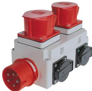
Die Holzmann ALA1\_400V Anlaufautomatik für Absauggeräte ermöglicht die Anbindung von bis zu zwei Arbeitsmaschinen an die Mastersteckdosen. Nach dem Einschalten der Arbeitsmaschine schaltet sich die Absaugung nach 2-4 Sekunden automatisch ein und läuft nach dem Abschalten der Maschine weitere 3-4 Sekunden, um den Reststaub abzusaugen.
