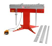
Die Holzmann AKM1250MAG\_230V ist eine kraftvolle, magnetische Schwenkbiegemaschine, die inklusive Pedal für eine komfortable, schnelle und einfache Bedienung sorgt. Sie bietet eine hohe Biegekapazität durch präzise Kraftübertragung und ist zum Biegen von Stahl, Aluminium, Edelstahl, Kupfer und mehr geeignet. Die saubere Biegerung wird durch die Klemmung über die gesamte Breite ermöglicht.
