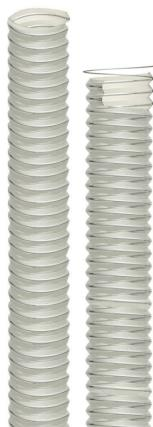
Der Holzmann ABS100MM\_10LFM Absaugschlauch ist ein hochwertiger Absaugschlauch aus PU (Polyurethan) mit einer Durchmesser von Ø 100mm und einer Länge von 10m. Der Schlauch ist verstärkt mit einer Stahlwendel mit Kupferbeschichtung und hat eine Wandstärke von 0,4 mm. Das Wandmaterial ist permanent antistatisch mit einem Widerstand von weniger als 1E9 Ohm/m und ist flammenhemmend nach UL 94-VO.
