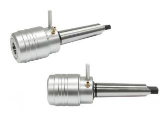
Der Bernardo Schnellwechsel-Werkzeughalter mit automatischer Innenkühlung MK 3 Zubehör Magnet-Kernbohrmaschinen ermöglicht einen schnellen Werkzeugwechsel ohne Spannschlüssel. Mit automatischer Innenkühlung für Kernbohrer mit Weldonschaft 19 mm ist dieser Werkzeughalter ideal für den Einsatz in der Metallverarbeitung.
