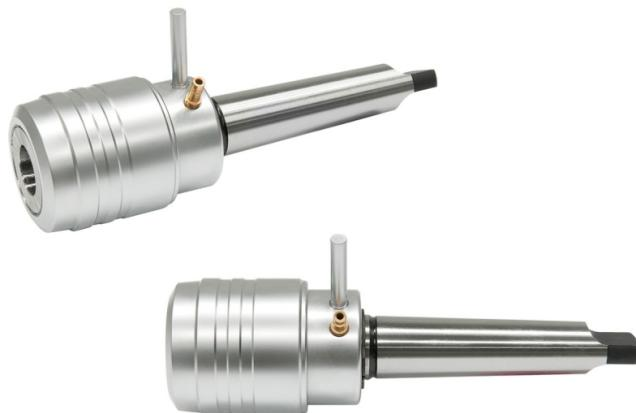
Der Bernardo Schnellwechsel-Werkzeughalter mit automatischer Innenkühlung MK 2 Zubehör Magnet-Kernbohrmaschinen ermöglicht einen schnellen Werkzeugwechsel ohne Spannschlüssel. Mit automatischer Innenkühlung für Kernbohrer mit Weldonschaft 19 mm ist dieser Werkzeughalter ideal für den Einsatz in der Metallverarbeitung.
