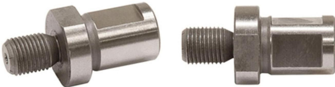
Der Bernardo Bohrfutteradapter 1/2"- 20 UNF / Weldon 19 mm ist ein Zubehör für Magnet-Kernbohrmaschinen. Er dient als Adapter von Weldon 19 mm auf 1/2"- 20 UNF und ermöglicht die Aufnahme von Zahnkranz- und Schnellspannbohrfutter.
