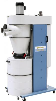
Die Reinluft-Absauganlagen der RLA-Serie verbessern durch die doppelte Spänefilterung (Zyklon bzw. Filterpatrone) die Leistungsfähigkeit ihrer Holzbearbeitungsmaschinen und halten daher den Arbeitsplatz späne- und staubfrei. Zusätzlich können diese Modelle auch zum Absaugen von Kunststoffen, Papierstäuben usw. eingesetzt werden.
