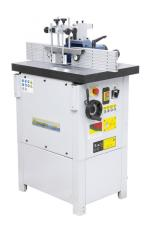
Die Tischfräsmaschine T 650 ist serienmäßig mit 4 Drehzahlen und einem Rechts-/Linkslauf ausgestattet, wodurch eine optimale Anpassung an das jeweilige Werkstück gewährleistet wird. Durch den optionalen Rolltisch wird das Bearbeiten größerer Werkstücke zusätzlich erleichtert.
