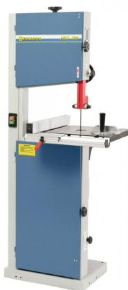
Die Holzbandsäge HBS 400 überzeugt durch den großen, geschliffenen Arbeitstisch sowie Laufräder aus Grauguss. Für den kostenbewussten Hobbyheimwerker ist diese Maschine das ideale Arbeitsgerät.
