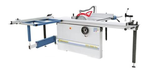
Die Formatkreissägen der FKS-Serie sind je nach Anwendung wahlweise mit drei verschiedenen Tischlängen lieferbar (2600 / 2800 / 3200 mm). Serienmäßig ausgestattet mit einem 3,8 kW Motor und einem Sägeblatt mit 315 mm Durchmesser für Schnitthöhen bis 100 mm, sowie einem Vorritzaggregat für ein ausreißfreies Bearbeiten beschichteter Plattenwerkstoffe.
