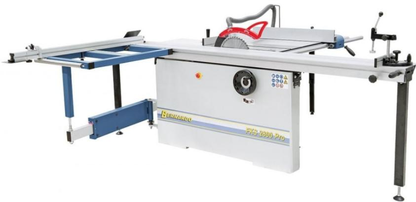
Die Formatkreissägen der FKS-Serie sind je nach Anwendung wahlweise mit drei verschiedenen Tischlängen lieferbar (2600 / 2800 / 3200 mm). Serienmäßig ausgestattet mit einem 3,8 kW Motor und einem Sägeblatt mit 315 mm Durchmesser für Schnitthöhen bis 100 mm, sowie einem Vorritzagggregat für ein ausreißfreies Bearbeiten beschichteter Plattenwerkstoffe.
