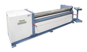
Die Bernardo MPR 2550 - 6,0 GMD Motorische Rundbiegemaschinen ist eine leistungsstarke Maschine für die Blechbearbeitung. Mit einer Walzenlänge von 2550 mm und einer maximalen Blechstärke von 6,0 mm ist sie ideal für verschiedene Anwendungen. Die Maschine verfügt über eine Vorbiegung von 5,0 mm und einen Walzendurchmesser von 190 mm. Der Mindestbiegedurchmesser beträgt 290 mm und die Walzengeschwindigkeit liegt bei 9 U/min.
