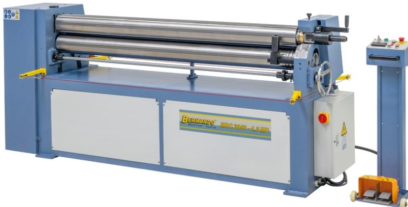
Die Bernardo MPR 2550 - 6,0 GMD Motorische Rundbiegemaschinen ist eine leistungsstarke Maschine für die Bearbeitung von Metall. Die Maschine verfügt über eine Walzenlänge von 2550 mm und kann Bleche mit einer Stärke von bis zu 6,0 mm bearbeiten. Die Vorbiegung beträgt 5,0 mm und der Walzendurchmesser 190 mm. Der Mindestbiegedurchmesser liegt bei 290 mm und die Walzengeschwindigkeit bei 9 U/min.
