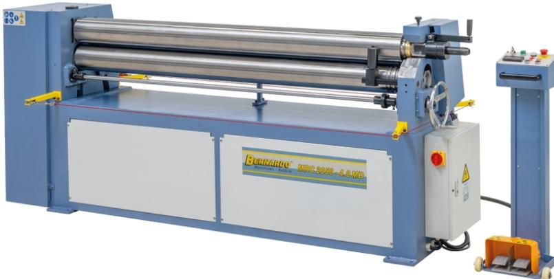
Die Bernardo MRC 2050 - 4,0 MD Motorische Rundbiegemaschinen ist eine leistungsstarke Maschine für die Bearbeitung von Metall. Die Maschine verfügt über eine Walzenlänge von 2050 mm und kann Bleche mit einer Stärke von bis zu 4,0 mm bearbeiten. Die Vorbiegung beträgt 3,0 mm und der Walzendurchmesser 150 mm. Die Mindestbiegedurchmesser betragen 230 mm und die Walzengeschwindigkeit 6 U/min.
