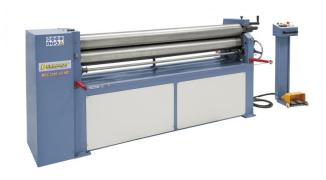
Die Bernardo MRC 2050 - 4,0 MD Motorische Rundbiegemaschinen ist eine leistungsstarke Maschine für die Blechverarbeitung. Mit einer Walzenlänge von 2050 mm und einer maximalen Blechstärke von 4,0 mm (S 235 JR+AR) ist sie ideal für verschiedene Anwendungen. Die Maschine verfügt über eine Vorbiegung von 3,0 mm und einen Walzendurchmesser von 150 mm. Der Mindestbiegedurchmesser beträgt 230 mm und die Walzengeschwindigkeit liegt bei 6 U/min.
