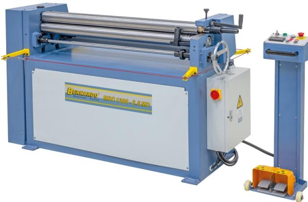
Die Bernardo MRC 1300 - 2,5 MD Motorische Rundbiegemaschinen ist eine äußerst robuste Stahlblechkonstruktion für präzises Arbeiten. Sie verfügt über eine ausschwenkbare Oberwalze für eine leichte Entnahme des fertigen Werkstückes und eine konischbiegeeinrichtung im Lieferumfang enthalten. Die Unterwalze ist über Handrad manuell justierbar und die Oberwalze ist festgelagert, während die Unter- und Hinterwalze verstellbar sind.
