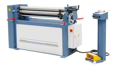
Die Bernardo MRC 1300 - 2,5 MD Motorische Rundbiegemaschinen ist eine leistungsstarke Maschine für die Bearbeitung von Metall. Die Maschine verfügt über eine Walzenlänge von 1300 mm und kann Bleche mit einer Maximalstärke von 2,5 mm bearbeiten. Die Vorbiegung beträgt 2,0 mm und der Walzendurchmesser 90 mm. Die Mindestbiegedurchmesser beträgt 135 mm und die Walzengeschwindigkeit 12 U/min. Die Motorleistung beträgt 1,1 kW.
