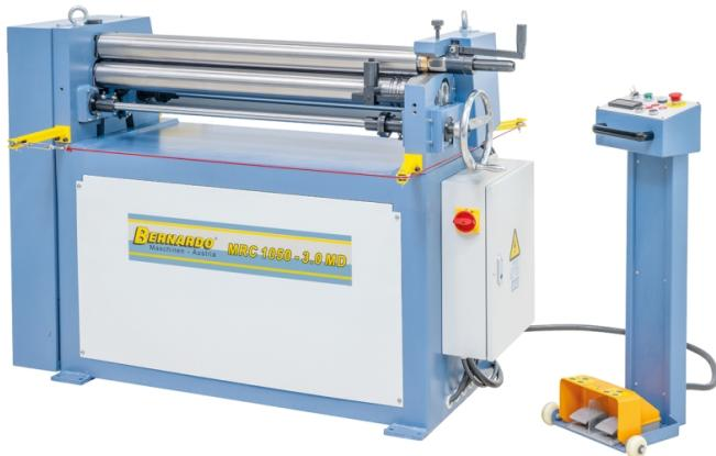
Die Bernardo MRC 1050 - 3,0 MD Motorische Rundbiegemaschinen ist eine äußerst robuste Stahlblechkonstruktion für präzises Arbeiten. Sie ist zum Einrollen von Stahl, Blech, Edelstahl und Aluminium geeignet. Die Maschine verfügt über eine ausschwenkbare Oberwalze für eine leichte Entnahme des fertigen Werkstückes und eine konischbiegeeinrichtung im Lieferumfang enthalten.
