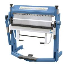
Die Bernardo TB 1020 Flex Schwenkbiegemaschinen mit segm, Ober-, Unter- und Biegewange sind universell einsetzbare Biegemaschinen für Spenglereien und Reparaturbetriebe. Durch Klaviereinsätze in der Ober-, Unter- und Biegewange ergibt sich eine große Anzahl von Biegemöglichkeiten. Kassetten und Spezialprofile mit entgegengesetzten Biegungen sind mit diesen Modellen leicht durchführbar.
