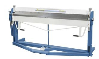
Die Bernardo TB 2060 Schwenkbiegemaschinen mit segmentierter Oberwange ist eine leistungsstarke Maschine für die Bearbeitung von Metall. Die Maschine verfügt über eine Arbeitslänge von 2065 mm und kann Bleche mit einer Maximalstärke von 1,2 mm bearbeiten. Die Maximalöffnungsweite beträgt 30 mm und der Biegewinkel kann zwischen 0 und 135° eingestellt werden.
