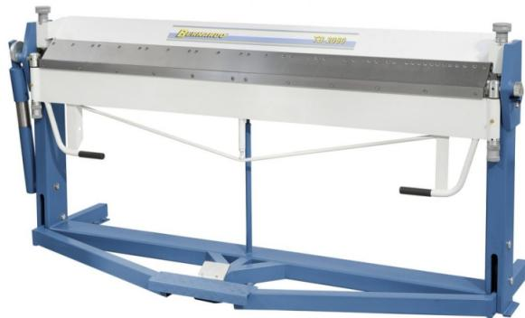
Die Bernardo TB 2060 Schwenkbiegemaschinen mit segmentierter Oberwange sind universell einsetzbare Biegemaschinen für Spenglereien und Reparaturbetriebe. Sie zeichnen sich durch eine robuste Bauweise im modernen Design aus. Die leichte Verstellung der Oberwange mittels Fußpedal ermöglicht es, die Hände frei für das Werkstück zu haben.
