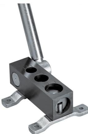
Der Bernardo RAA Rohrausklinker ist ein vielseitiges Werkzeug zum Ausklinken von Dampf-, Edelstahl-, Gas-, NE- und anderen Rohren bis 3 mm Wandstärke. Es ermöglicht auch das Zusammensetzen und Verschweißen von Rohren im 90° Winkel. Durch die Kombination verschiedener Rohrdurchmesser in einem Gerät wird eine hohe Produktivität bei geringer Investition erreicht.
