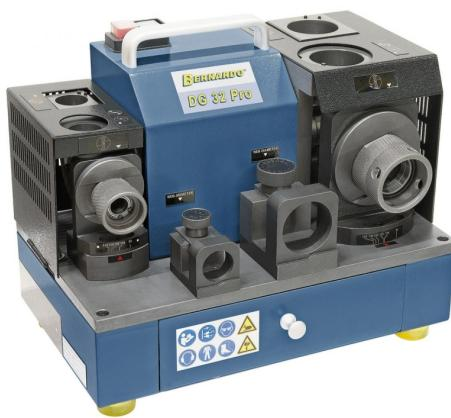
Die Bohrschleifmaschine DG 32 Pro ist für alle gängigen 2-schneidigen Spiralbohrer aus HSS, Kobalt oder Hartmetall und dergleichen von 2 - 32 mm geeignet. Der Vorteil dieses Modells ist die Möglichkeit zum Hinterschleifen der Schneidflächen, wodurch ein perfektes Bohrergebnis gewährleistet wird. Hohe Wirtschaftlichkeit durch den schnellen Schleifvorgang bei geringen Investitionskosten.
