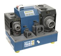
Die Bohrerschleifmaschine DG 32 Pro ist für alle gängigen 2-schneidigen Spiralbohrer aus HSS, Kobalt oder Hartmetall und dergleichen von 2 – 32 mm geeignet. Der Vorteil dieses Modells ist die Möglichkeit zum Hinterschleifen der Schneidflächen, wodurch ein perfektes Bohrergebnis gewährleistet wird. Hohe Wirtschaftlichkeit durch den schnellen Schleifvorgang bei geringen Investitionskosten.
