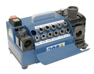
Die handliche Bohrerschleifmaschine DG 13 M ist ideal zum Schleifen von Spiralbohrern aus HSS und Hartmetall. Durch den einstellbaren Spitzenwinkel von 90° bis 135° ist dieses Modell universell einsetzbar für 2-schneidige Spiralbohrer.
