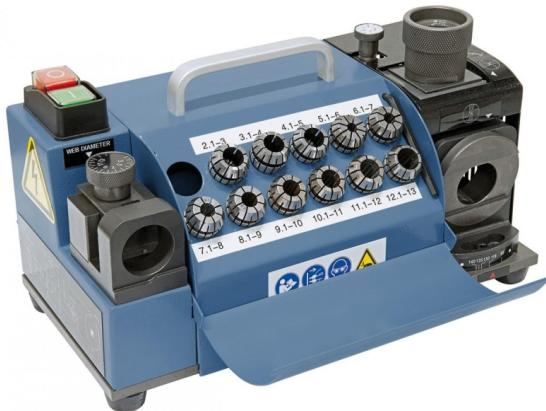
Die handliche Bohrschleifmaschine DG 13 M ist ideal zum Schleifen von Spiralbohrern aus HSS und Hartmetall. Durch den einstellbaren Spitzenwinkel von 90° bis 135° ist dieses Modell universell einsetzbar für 2-schneidige Spiralbohrer.
