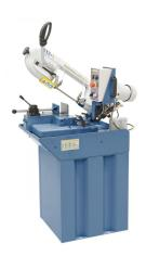
Die kompakte Horizontalbandsäge HBS 150 Z ist serienmäßig mit einer stufenlos einstellbaren Schnittgeschwindigkeit sowie einer Kühlmitteleinrichtung ausgestattet. Für Gehrungsschnitte ist der Sägebügel bis 60° schwenkbar.
