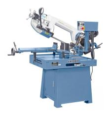
Die kompakte Doppelgehrungsbandsäge MCB 320 eco mit dem schwenkbaren Sägebügel ermöglicht ein platzsparendes Arbeiten, da die Position des Materials bei Gehrungsschnitten nicht verändert werden muss. Merkmale dieser Maschine ist die Vorrichtung zum Umstellen auf manuellen Betrieb, der verschiebbare Schraubstock mit Schnellarretierung sowie die automatische Bandbruchkontrolle.
