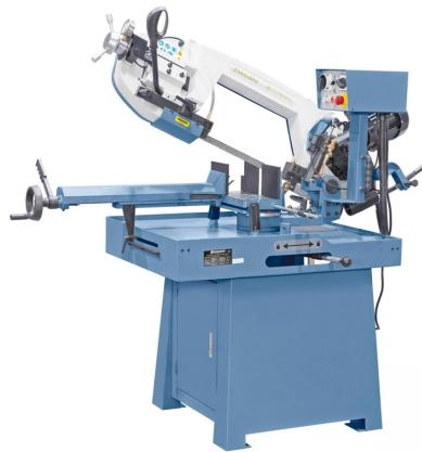
Die kompakte Doppelgehrungsbandsäge MCB 320 eco mit dem schwenkbaren Sägebügel ermöglicht ein platzsparendes Arbeiten, da die Position des Materials bei Gehrungsschnitten nicht verändert werden muss. Merkmale dieser Maschine sind die Vorrichtung zum Umstellen auf manuellen Betrieb, der verschiebbare Schraubstock mit Schnellarretierung sowie die automatische Bandbruchkontrolle.
