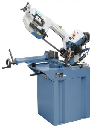
Das Modell MCB 270 eco ist eine präzise Horizontalbandsäge für den universellen Einsatz. Merkmale dieser Maschine sind der Hydraulikzylinder zum feinfühligem Absenken des Sägebügels sowie die integrierte Kühlmitteleinrichtung.
