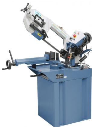
Das Modell MCB 270 eco ist eine präzise Horizontalbandsäge für den universellen Einsatz. Merkmale dieser Maschine sind der Hydraulikzylinder zum feinfühligen Absenken des Sägebügels sowie die integrierte Kühlmitteleinrichtung.
