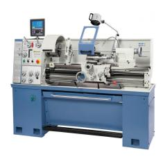
Die Master 400 ist eine kompakt gebaute Universaldrehmaschine mit großem Einsatzbereich und überzeugt vor allem durch den Drehdurchmesser von 400 mm, sowie der Spindelbohrung von 52 mm. Aufgrund ihrer Konstruktion (Bauart, Leistung, Vorschübe,...) kann sie sowohl in Ausbildungswerkstätten, aber auch für den Werkzeugbau und Reparaturbetriebe erfolgreich eingesetzt werden.
