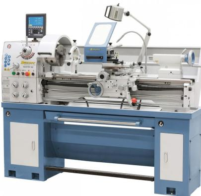
Die Leit- und Zugspindeldrehmaschine Master 180 überzeugt durch ihre stabile Konstruktion und einfache Handhabung. Schon die Grundausstattung beinhaltet alle wichtigen Zubehöre, wodurch diese Maschine ideal für Fachschulen, Reparaturbetriebe und Ausbildungswerkstätten ist.
