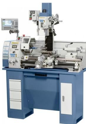
Unser Topmodell Proficenter 700 BQV lässt für Feinmechaniker, Ausbildungs- und Lehrwerkstätten keine Wünsche offen. Bohren, Fräsen und Drehen auf kleinstem Raum, serienmäßig mit digitaler Anzeige für Bohrtiefe und Drehzahl zum komfortablen Arbeiten, sowie eine große Spindelbohrung, alles kombiniert in einer Maschine. Zur Reduzierung der Fertigungszeiten ist dieses Modell mit einer 2-Achs-Digitalanzeige ausgestattet.
