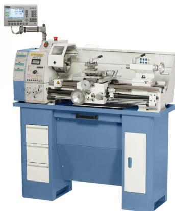
Die Drehmaschine Profi 700 Top ist unser neues Modell, das serienmäßig mit einem hochwertigen Delta-Frequenzumrichter ausgestattet ist. Wesentliche Vorteile, die sich daraus ergeben, sind das hohe Drehmoment im unteren Drehzahlbereich und die annähernd konstante Drehzahl unter Last.
