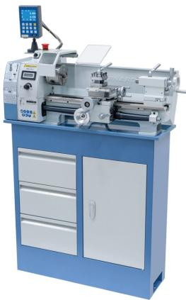
Die Tischdrehmaschine Profi 400 V ist serienmäßig mit einer stufenlosen Drehzahlregelung ausgestattet, das Ablesen der eingestellten Drehzahl erfolgt mittels Digitalanzeige. Durch das optimale Preis - Leistungsverhältnis ist dieses Modell ideal für Modellbauer und Hobby-Heimwerker.
