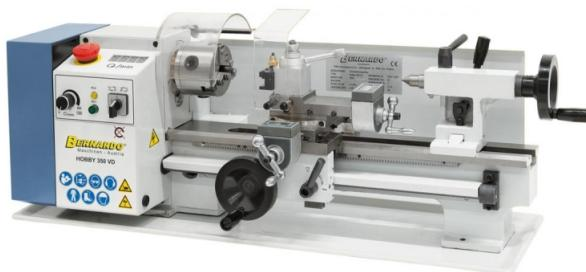
Die Tischdrehmaschine Hobby 350 VD bietet zusätzlich - im Gegensatz zur Hobby 300 VD - eine um 50 mm größere Spitzenweite, eine digitale Drehzahlanzeige zum einfachen Ablesen der Drehzahl sowie einen stärkeren Antriebsmotor. Durch das überzeugende Preis-Leistungsverhältnis ist dieses Modell ideal für Modellbauer und Hobby-Heimwerker.
