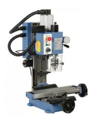
Die Fräsmaschine KF 20 Super bietet durch den bürstenlosen Gleichstrommotor eine hohe Laufruhe sowie einen gleichmäßigen Antrieb der Spindel über den gesamten Drehzahlbereich.
