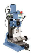
Die Bohr- und Fräsmaschine KF 10 ist durch ihre kleine Bauweise für die Bohr- und Fräsarbeiten des Bastlers und Hobbyheimwerkers bestens geeignet.
