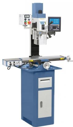
Die Bohr- und Fräsmaschine KF 25 Pro ist aufgrund der hohen Drehzahl bis 3000 U/min, dem leistungsstarken Antriebsmotor (900 W) und der Spindelaufnahme MK 3 das ideale Modell für den anspruchsvollen Anwender. Zur Reduzierung der Fertigungszeiten ist dieses Modell mit einer 3-Achs-Positionsanzeige und einem stufenlos regelbarem Frästischvorschub ausgestattet.
