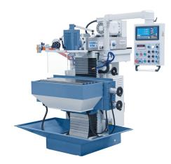
Die Werkzeugfräsmaschine WFM 750 Servo ist für die Bearbeitung von Werkstückgewichten bis 200 kg ausgelegt. Durch die stabile und schwere Graugusskonstruktion und der hohen Steifigkeit der Maschinenbaugruppen erfüllt dieses Modell die besten Voraussetzungen für genaues Arbeiten. Hauptmerkmale dieser Maschine ist der Servoantrieb mit elektronischen Handrädern in allen Achsen sowie die stufenlose Drehzahlregelung.
