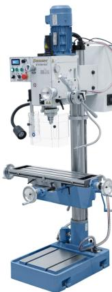
Mit der Bohr- und Fräsmaschine BF 45 HSV Vario hat man die Möglichkeit Bohr- und Fräsarbeiten in horizontaler, vertikaler und schräger Ebene durchzuführen. Durch die kompakte Bauweise, dem serienmäßigen Pinolenvorschub, der digitalen Pinolenhubanzeige und der stufenlosen Drehzahlregelung ist dieses Modell für Modellbauer, Handwerker und Reparaturwerkstätten optimal geeignet.
