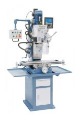
Die Bohr- und Fräsmaschine FM 50 HSV bietet durch die motorische Höhenverstellung des Fräskopfes, der digitalen Pinolenhubanzeige sowie dem automatischem Pinolenvorschub eine hohen Bedienkomfort. Durch die kompakte Bauweise und dem großen Leistungsbereich ist dieses Modell optimal geeignet für Modellbauer, Handwerker und Reparaturwerkstätten.
