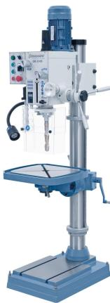
Die Getriebe-Säulenbohrmaschinen GB 35 HS zeichnet sich durch ihre robuste und vibrationsfreie Bauweise aus. Durch den dreh- und schwenkbaren Getriebekopf ist diese Maschine für den allgemeinen Werkstätteneinsatz geeignet.
