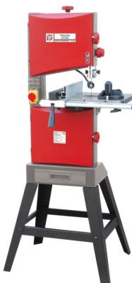
Die Holzmann HBS245HQ\_230V Holzbandsäge ist eine präzise und leistungsstarke Maschine für die Holzbearbeitung. Der Graugusstisch ist bis 45° nach vorne schwenkbar und verfügt über eine präzise geschliffene und polierte Oberfläche. Die Laufrollen aus Alu-Druckguss mit spezieller Gummibeschichtung sorgen für eine lange Lebensdauer des Bandsägeblattes.
